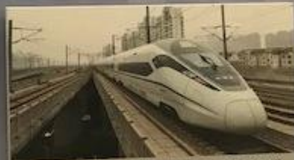
CRH380D型动车组列车，时速350公里，功率10000千瓦。
