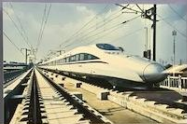
CRH380A型动车组列车，时速350公里，功率9120千瓦。
